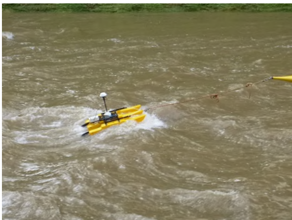
Abb. 3: Das kleine Messboot liefert Aufzeichnungen zur Abflussmenge in einem Gewässer. ADCP beschreibt das verwendete Gerät, einen Acoustic Doppler Current Profiler, übersetzt Ultraschall-Doppler-Profil-Strömungsmesser. Foto: Wasserwirtschaftsamt Traunstein
