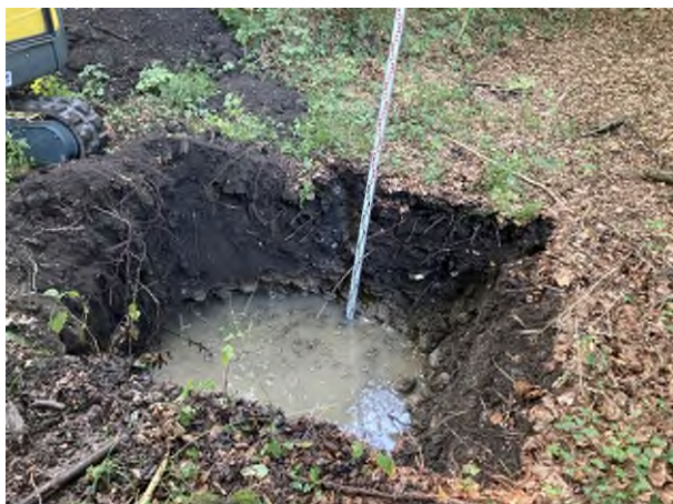
Abbildung 1: Die Probeschürfe in dem ausgetrockneten Seitenarm der Alz bei Altenmarkt haben ergeben, dass nur eine dünne Oberbodenschicht vorhanden ist. Das Wasserwirtschaftsamt Traunstein geht davon aus, dass der Seitenarm vollständig im Kiesbett der Alz liegen wird.
